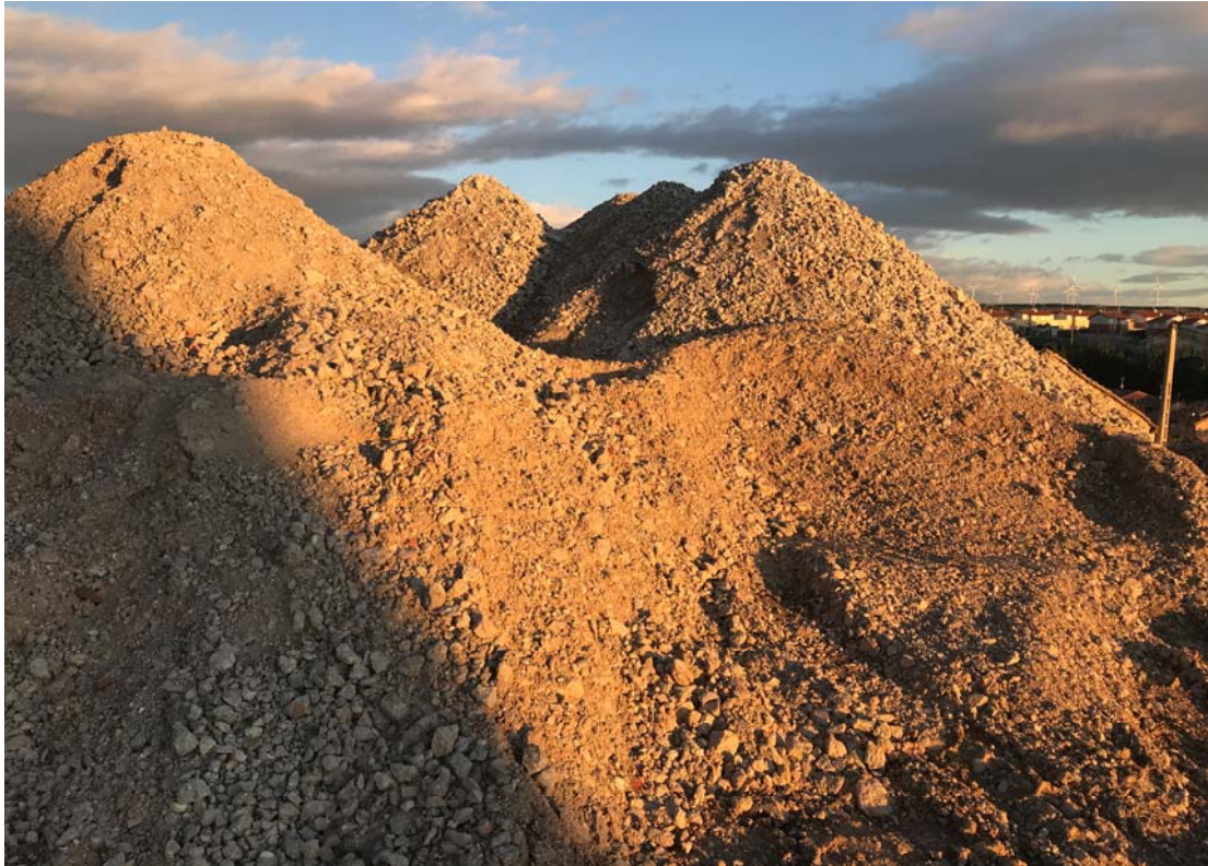
Fotografía de acopio de árido reciclado (No RCD).
