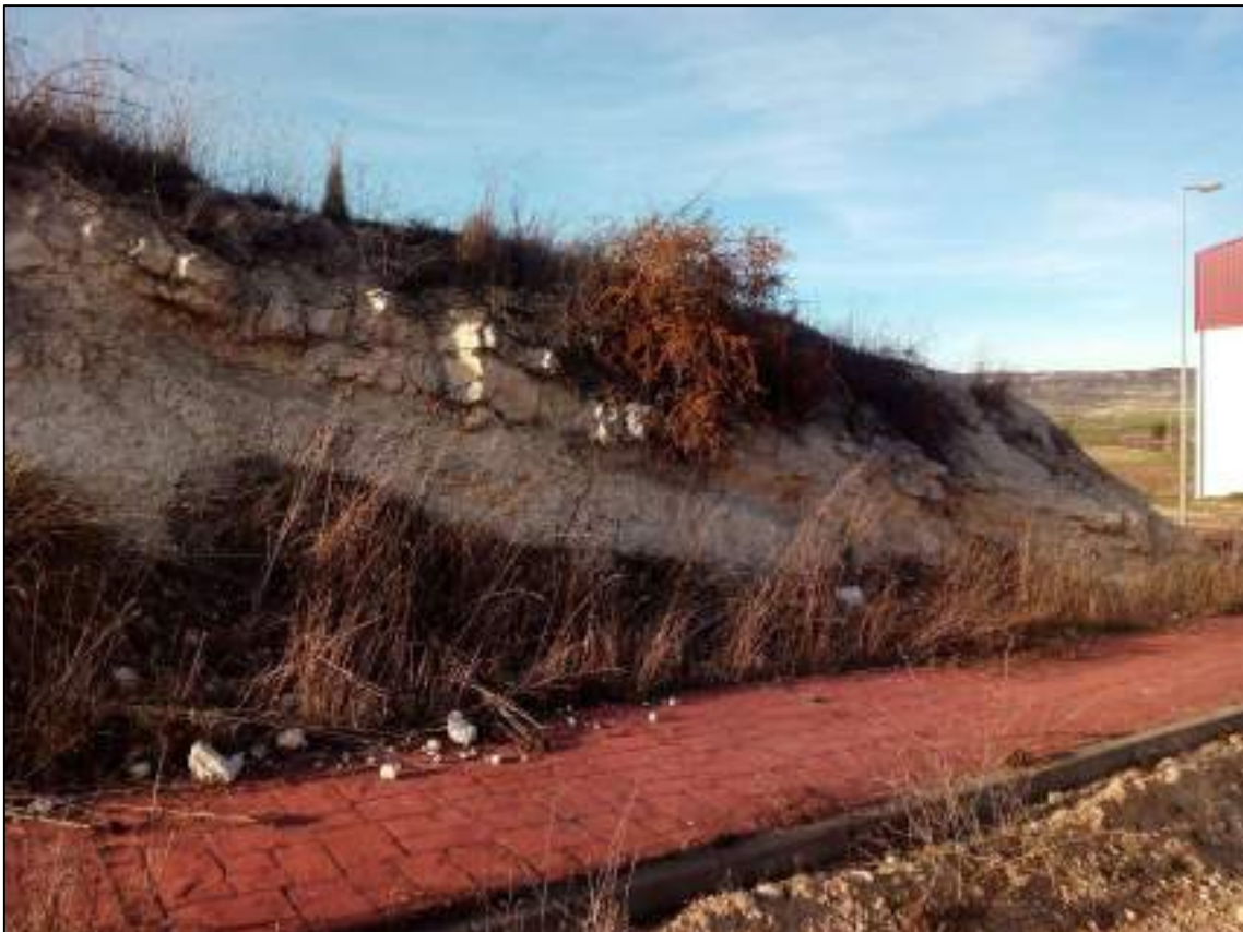
Imagen nº4. Sección de desmorte en la calle Las Paredillas. Capa delgada de marga intercalada en arcilla blanca.
