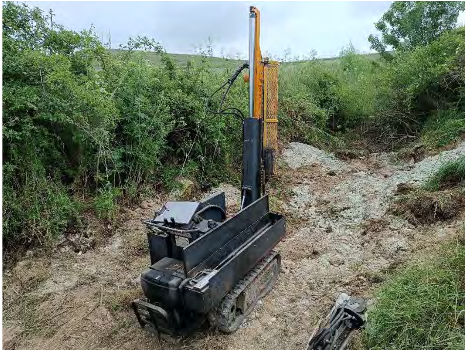
Penetrómetro DPSH-B utilizado en los ensayos de penetración.
