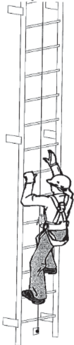
escalera fija >7 m.
