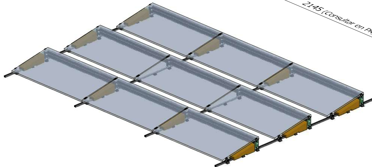
Montaje de una mesa de 3x3 paneles
