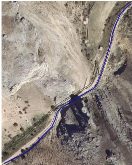
Imagen 2 y 3, de todo el camino y detalle, en azul el tramo donde se debe perfilar el talud, al SE.
